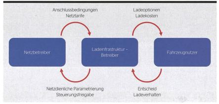
Bild 2 Im Ladeprozess von Elektrofahrzeugen involvierte Rollen.
