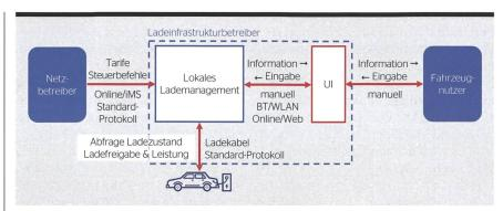
Bild 3 Technische Auslegung eines Lademanagement-Systems.
