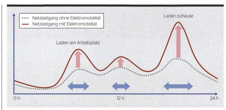
**Bild 1** Typischer Lastgang eines Netzgebiets mit und ohne Elektromobilität im Tagesverlauf
