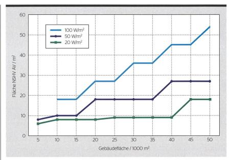
Flächenbedarf für Niederspannungsschaltanlagen in Abhängigkeit von der Installationsdichte.
