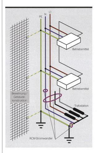
**Bild 2** Prinzipdarstellung Netzstruktur TN-S-System (in Anlehnung an 4.4.4 Figur 3) mit Darstellung von Möglichkeiten der Integration von Differenzstromüberwachungseinrichtung (RCM-Stromwandler).
