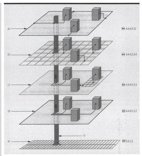
**Bild 5** Beispiele von Potenzialausgleichsanlagen in einem Gebäude mit mehreren Stockwerken ohne Blitzschutzanlage (4.4.4 Figur 20), **a)** Potenzialausgleichsnetzwerk durch geschlossene Leiterschleife (BRC), **b)** Vermaschtes sternförmiges Verbindungsnetzwerk **c)** Mehrfachverbindung vermaschtes, sternförmiges Netzwerk, **d)** Sternförmiges Netzwerk der Schutzleiter, **e)** Fundamenterder, **f)** Metallene Gebäudekonstruktion.
