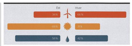
**Figure 1** Contrairement aux installations solaires et aux centrales hydroélectriques, les éoliennes produisent le plus en hiver, au moment où la consommation d'électricité pour le chauffage et pour l'éclairage augmente. En combinant l'éolien, le solaire et l'hydraulique, il est possible de disposer d'un approvisionnement en courant local toute l'année, sans émissions de CO<sub>2</sub>.
