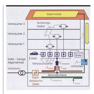
**Bild 1** Stromflüsse beim Zusammenschluss zum Eigenverbrauch.
