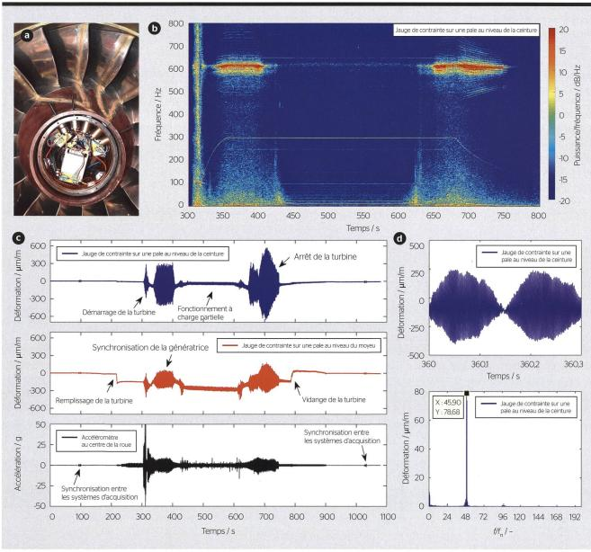
**Figure 2** Setup expérimental pour les mesures embarquées sur un prototype de turbine de Grimsel II (a) et analyse des contraintes et des vibrations au niveau de la roue pour un cycle complet de démarrage/arrêt en mode turbine (b, c et d).
