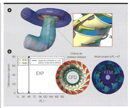
**Figure 3** Évidence des structures tourbillonnaires dans les canaux de la roue de la turbine obtenues par calcul CFD au régime d'emballement (a); 4<sup>e</sup> mode de déformation naturelle de la structure de la roue obtenu par calcul FEM avec mise en évidence des zones de déformation maximales (b).
