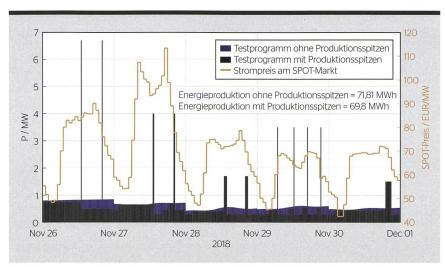
Während der ersten Messkampagne im November 2018 wurden elf Produktionsspitzen zwischen 15 Minuten und zwei Stunden realisiert. Diese wurden so terminiert, dass der Strom in Perioden mit hohen Marktpreisen (gelbe Kurve) erzeugt wurde. In diesen Zeiträumen generierte das Kraftwerk eine Leistung, die ein Vielfaches der Normalleistung betrug. Blau: Leistung des Kraftwerks ohne Produktionsspitzen.
