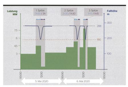
In der zweiten Testkampagne wurde das gesamte identifizierte Speichervolumen für die Produktion von Spitzenenergie genutzt. An zwei Tagen wurden drei Produktionsspitzen erzeugt, um verschiedene Geschwindigkeiten der Niveauabsenkung und der Befüllung im Druckstollen zu testen und die geringstmögliche Fallhöhe für den sicheren Betrieb der Turbinen zu bewerten.
