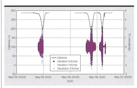
Drei Versuche im Mai 2020, während derer der Druckstollen teilweise entleert wurde. Unterschreitet der Wasserspiegel im Druckstollen die Marke von ca. 210 m, treten am Turbinenlaufrad Vibrationen auf.
