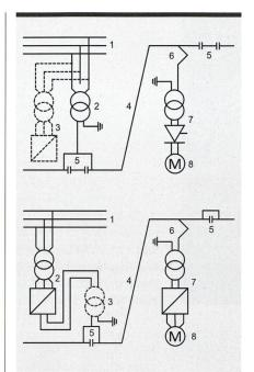
**Bild 1** Vereinfachte Schemata für die Versorgung von 50-Hz-Bahnen konventionell (oben) und neu (unten).
