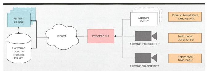
Figure 1 Schéma de principe avec les composants utilisés pour la collecte des données.
