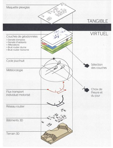
**Figure 5** Schéma montrant les couches physiques et digitales composant la maquette hybride CityPulse. Les données pouvant être modifiées en temps réel par les utilisateurs sont également indiquées.
