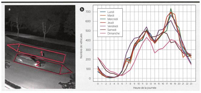
**Figure 2** Vue de la caméra Flir avec configuration des axes pour le comptage (a) et fluctuation du trafic quotidien sur l'axe Pérolles en direction de la sortie de Fribourg (b).
