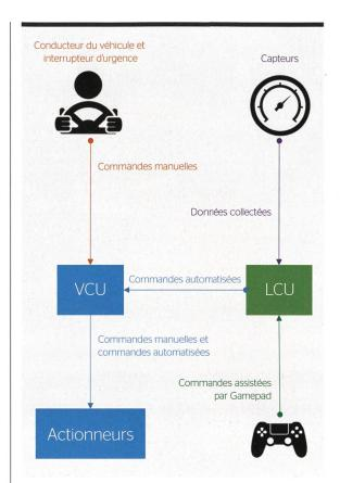
Schéma de communication entre les différents acteurs de la conduite manuelle et automatisée.
