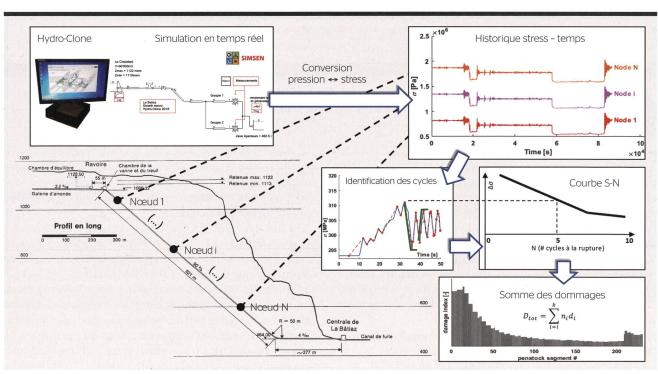
Figure 3 Méthodologie globale du concept de monitoring de la fatigue des conduites forcées.
