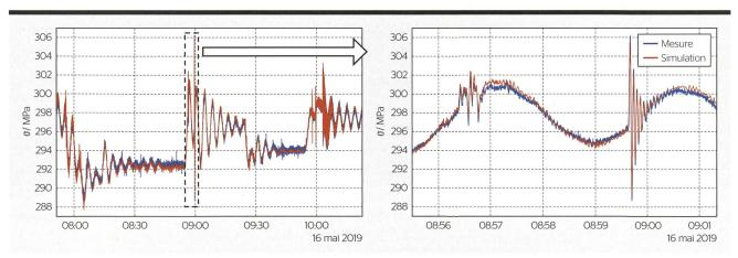
Figure 2 Comparaison de la contrainte mesurée au bas de la conduite forcée (en bleu) avec la valeur calculée par Hydro-Clone (en orange).
