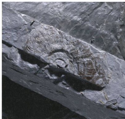
Das rund 175 Millionen Jahre alte Gestein Opalinuston ist praktisch undurchlässig und schliesst Stoffe sehr gut ein.
