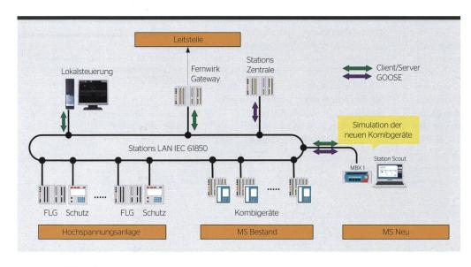
**Bild 2** Prüfung der Fernund Lokalsteuerung mit simulierten Kombigeräten der neuen MS-Anlage.
