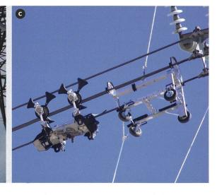
Figure 4 Déploiement du LineRanger.
