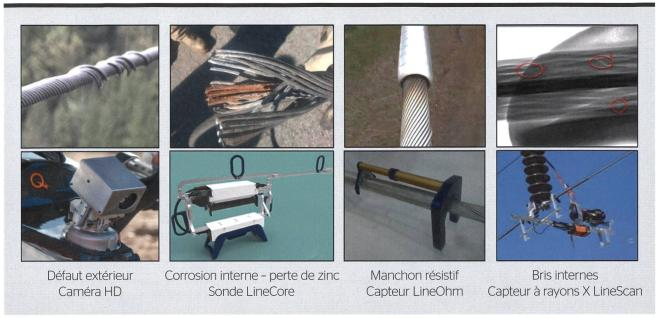
Figure 1 Mécanismes de dégradation et capteurs d'essais non destructifs (END) associés.
