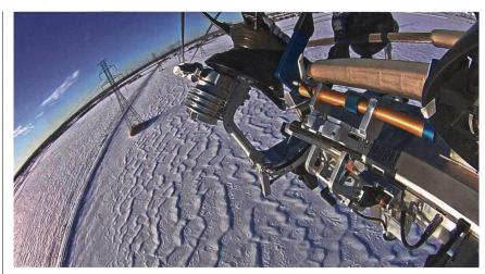
Figure 5 Réalisation de mesures sur un manchon de jonction, sous une tension de 735 kV.
