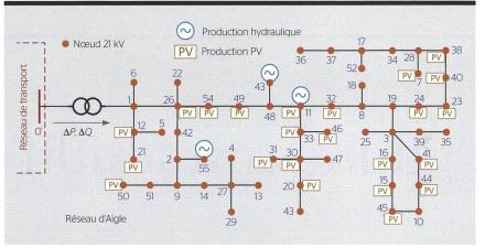
Figure 2 Schéma électrique du réseau d'Aigle.
