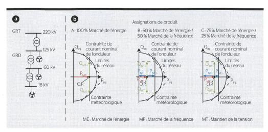
Figure 4 Schéma du réseau étudié (a) et assignations de produit et contraintes (b).
