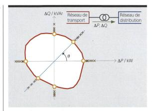
Figure 1 Flexibilité proposée par un réseau de distribution.
