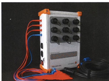
Die PQLP-Box kommuniziert via Ethernet.
