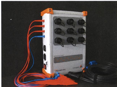
Die PQLP-Box kommuniziert via Ethernet.
