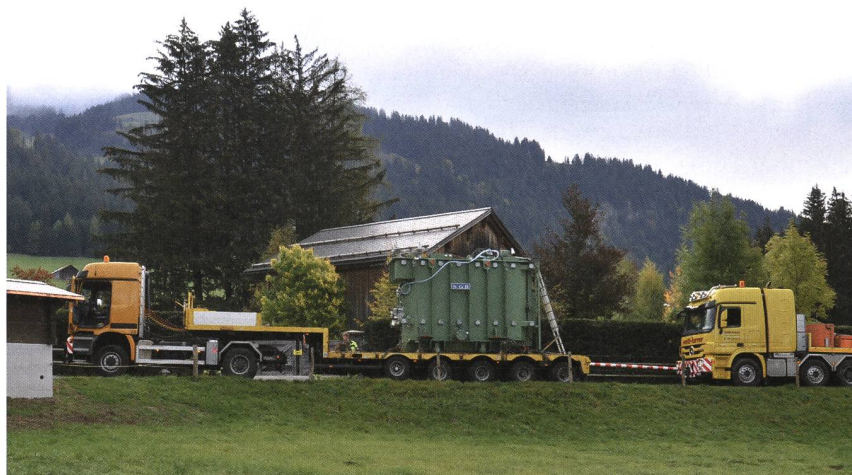
Bild 4 Transport eines Trafos in Saanen (BKW).
