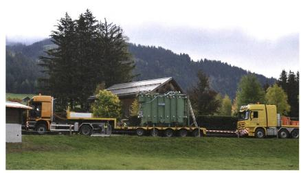
Bild 4 Transport eines Trafos in Saanen (BKW).
