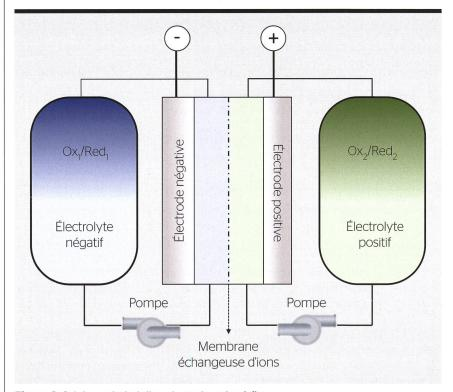
Figure 2 Schéma général d'une batterie redox à flux.
