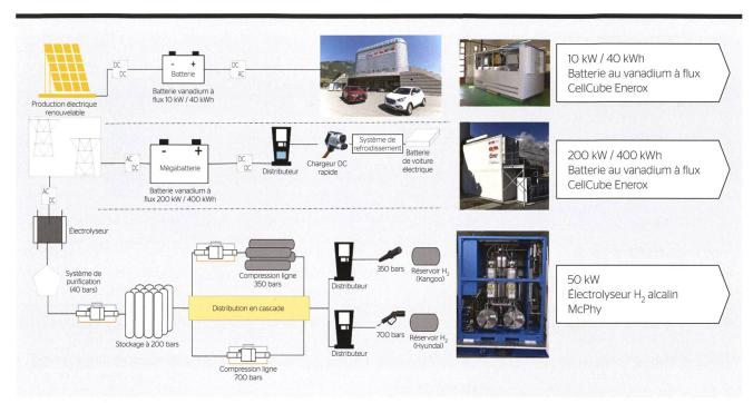
Figure 4 Plan du site de démonstration Electromobilis de l'EPFL.
