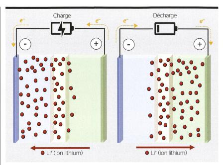
Figure 1 Schéma général d'une batterie lithium-ion.
