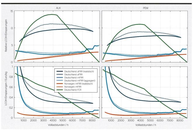
**Bild 3** Relative LCOH-Einsparungen (oben) und absolute LCOH-Einsparungen (unten) aufgrund von Regelleistungen für ALK- (links) und PEM-Wasserstoffelektrolyseure (rechts), in Abhängigkeit der jährlichen Volllaststunden. Die Fälle «realistisch» beziehen sich auf synthetisch berechnete 4-Stunden-Verträge, die die Auswirkung der Vertragslaufzeit auf den Wert der asymmetrischen Regelleistungsprodukte (aFRR, mFRR) berücksichtigen.
