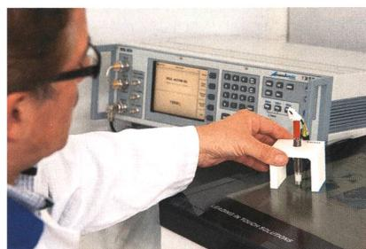
EMF-Prüfaufbau für Touchpanels.
