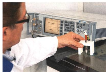
EMF-Prüfaufbau für Touchpanels.
