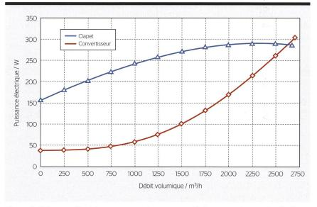
**Figure 2** Puissance électrique consommée par un ventilateur pour deux technologies différentes de contrôle du débit d'air.
