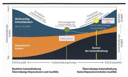
**Bild 4** Ermittlung eines optimalen Instandhaltungsniveaus in Abhängigkeit von der gewählten Instandhaltungsstrategie.[3]
