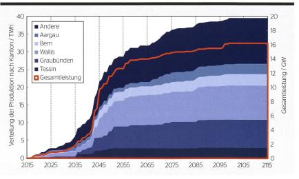
Bild 1 Entwicklung Konzessionsende von Wasserkraftanlagen in der Schweiz.
