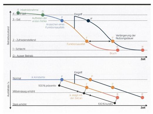
**Bild 3** Definition der Betriebszustände einer Anlage.
