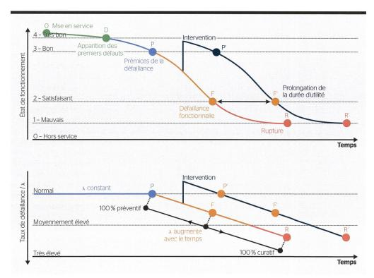
**Figure 3** Définition des états de fonctionnement d'un actif.
