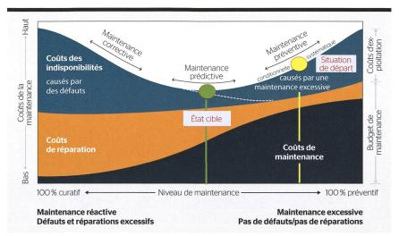
Figure 4 Recherche d'un optimum en fonction du degré de prévention de la stratégie de maintenance [3]
