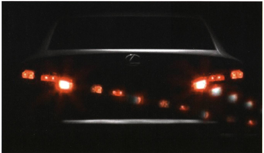
Bild 2 Der Perlschnureffekt entsteht, wenn man eine stehende, schwankende Lichtquelle betrachtet und den Blickwinkel ändert.
