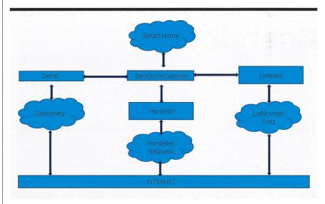
Bild 2 Einbindung eines Smart-Home-Systems in weitere Systeme.
