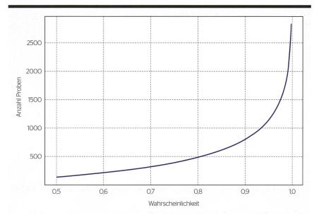
**Bild 5** Anzahl der nötigen Proben in Abhängigkeit vom Vertrauensintervall. Mit einer Stichprobe von etwa 500 lässt sich der Mittelwert mit einem Fehler  $\pm 10\,\%$  zu 80 % Wahrscheinlichkeit vorhersagen.
