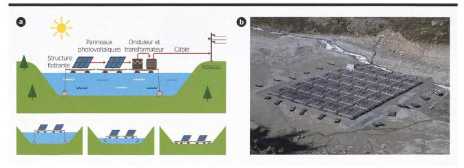
Figure 2 Le parc flottant s'adapte au fur et à mesure au marnage (a) et va jusqu'à se poser sur le fond du lac à bas niveau d'eau (b).
