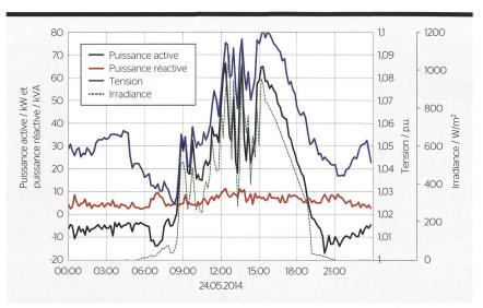
**Figure 1** Évolution mesurée de la tension (bleu), de la puissance active (noir), de la puissance réactive (rouge) et de l'irradiance (vert) au cours d'un samedi fluctuant de mai 2014 en un point critique du réseau de Dettighofen. La tension dépasse la limite de 110 % pendant une bref instant (moins de 10 min).
