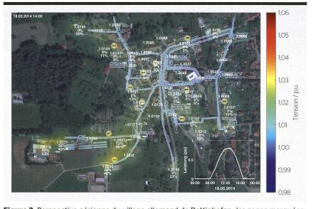
**Figure 2** Perspective aérienne du village allemand de Dettighofen: les zones marquées en jaune représentent les endroits où les tensions sont plus élevées. Le réglage des puissances active et réactive est utilisé dans ce réseau.
