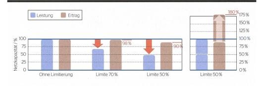
**Bild 3** Mehrertrag gesamtheitlich bei gegebener Netzkapazität.
