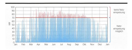
**Bild 1** Limitierung bei 70 % der maximalen PV-Panel-Peak-Leistung (Beispiel-Anlage).
