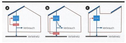
Bild 4 a) Statische Begrenzung der PV-Leistung; b) Begrenzung der Netzeinspeisung; c) Abregelung abhängig vom Netzzustand.
