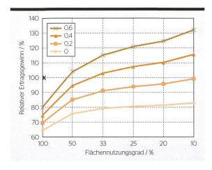
Bild 3 Simulierter spezifischer Ertrag (kWh/kW Nennleistung) eines Ost/ West-orientierten, vertikalen, bifazialen Systems (GCR und Albedo variiert). Im Vergleich dazu der spezifische Ertrag eines monofazialen Systems (Ost/West) gleicher frontseitiger Nennleistung mit 10 ° Kippwinkel und 100 % GCR [17].
