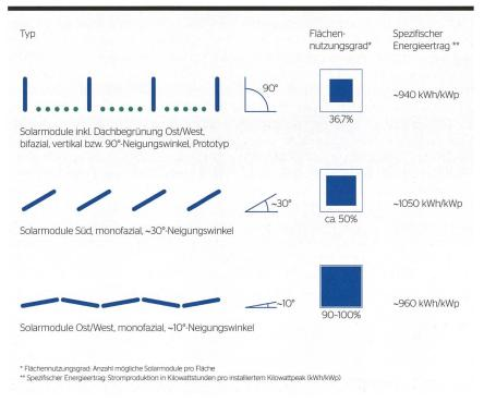
**Bild 2** Flächennutzungsgrad und spezifischer Energieertrag der im Einstiegsbild gezeigten Anlage (oben) im Vergleich mit weiteren typischen Installationstypen von Dachanlagen mit monofazialen Modulen.
