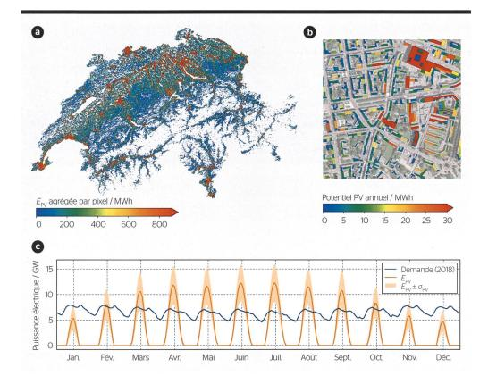
Figure 4 Distribution spatiale du potentiel technique annuel, agrégé en pixels de 500 x 500 m<sup>2</sup> à des fins de visualisation (a), potentiel technique annuel pour les toitures appropriées d'un pixel de 500 x 500 m<sup>2</sup> choisi au hasard dans la ville de Genève (b), et profils mensuels movens horaires du potentiel technique additionné pour toutes les toitures considérées comme appropriées, leurs incertitudes, et demande suisse d'électricité en 2018 (c).
