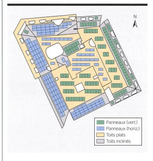
Figure 2 Installation virtuelle de panneaux photovoltaïques après retrait des superstructures du toit: la meilleure configuration de panneaux orientés verticalement et horizontalement est sélectionnée.
