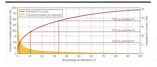
Figure 3 Puissance installée par bâtiment et potentiel technique RPV cumulé en fonction du pourcentage de bâtiments considérés comme appropriés.
