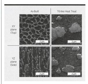
Nach dem Lasersintern sind die Metalle in der Legierung kleinräumig verteilt (links). Durch die T6-Wärmebehandlung (rechts) werden die Regionen grösser und die Leitfähigkeit dadurch verbessert.[1]
