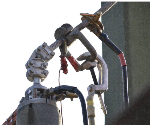
Die Messung des Übergangswiderstands zeigt, dass die additiv gefertigte Abgangsklemme genau gleich wie konventionell gefertigte Klemmen eingesetzt werden kann.
