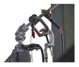
Die Messung des Übergangwiderstands zeigt, dass die additiv gefertigte Abgangsklemme genau gleich wie konventionell gefertigte Klemmen eingesetzt werden kann.
