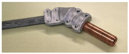
Für die Ersatzklemme wurde dieselbe Aluminiumlegierung AlSi10Mg genutzt, die auch für Gussteile eingesetzt wird.
