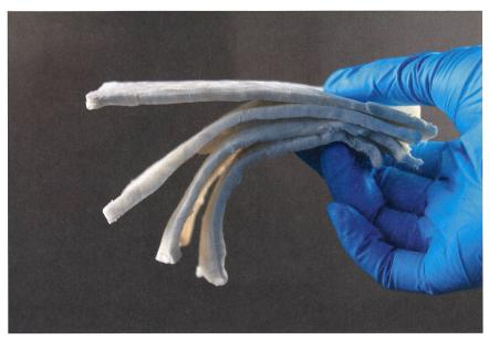
Eine Probe des neuen elektromagnetischen Abschirmmaterials.
