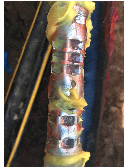
Bild 1 Teilentladungen können beispielsweise durch die Verwendung eines falschen Presswerkzeugs entstehen.
