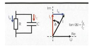
**Bild 2** Der Verlustfaktor entspricht dem Verhältnis zwischen einer reellen und einer imaginären Grösse.
