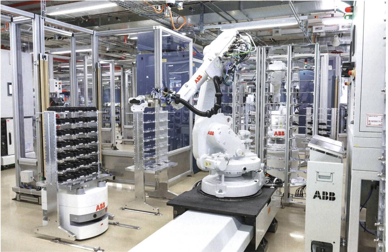
Un AGV (Automated Guided Vehicle) alimente une cellule robotisée avec un module semi-conducteur.
