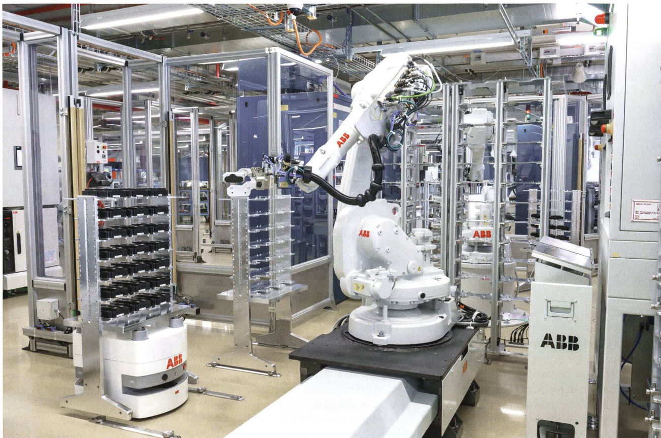
Eine Roboterzelle wird mittels eines AGV mit einem Halbleitermodulloos beschickt.
