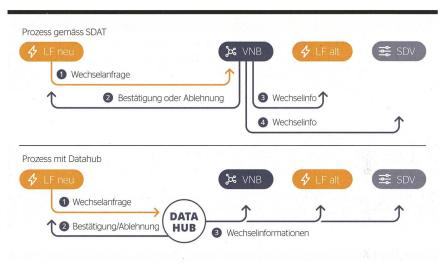
Bild 2 Ergänzend zur Routing-Funktionalität führt der Swisseldex Datahub auch ein Messpunkteregister, das mittels Shortcuts für den Netzbetreiber eine vereinfachte Abwicklung der Wechselprozesse ermöglicht.
