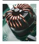
Eine stromkompensierte Hochstromdrossel.
