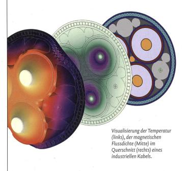
Beim Kabeldesign ist es wichtig, kapazitive, induktive und thermische Effekte in den Kabelteilen zu berücksichtigen. So führen beispielsweise unterschiedliche Bonding-Typen zu spezifischem Stromaufbau und -Verlust. Ebenso beeinflussen Außenleiter und Schutzwicklung die Stromverteilung im Kabel. Wenn Sie diese Information im Voraus kennen, können Sie fundierte Designentscheidungen treffen. Hierbei hilft Ihnen die Elektromagnetik-Simulation.
