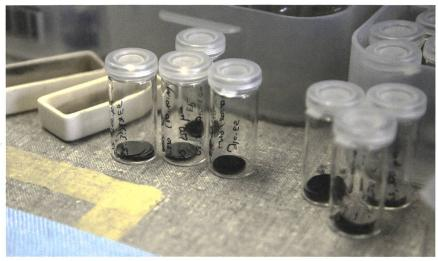
Ausgestanzte Elektroden, die später in Knopfzellenbatterien eingebaut werden.
