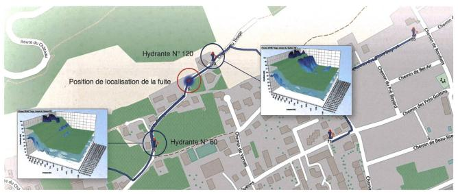
Figure 3 Localisation de fuite d'eau par corrélation de plusieurs sonogrammes mesurés simultanément.
