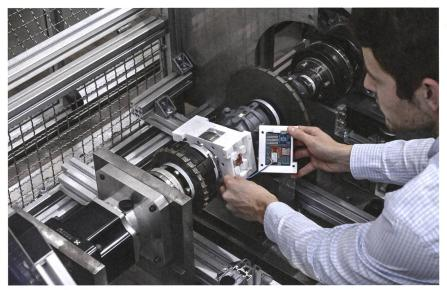
Auf einer Antriebswelle angebrachter energieautarker Beschleunigungssensor.
