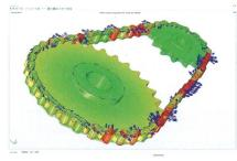
Analyse eines elastischen Kettenantriebes.
