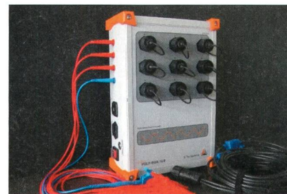
PQLP-Box ist ein Dreiphasen-Messsystem.
