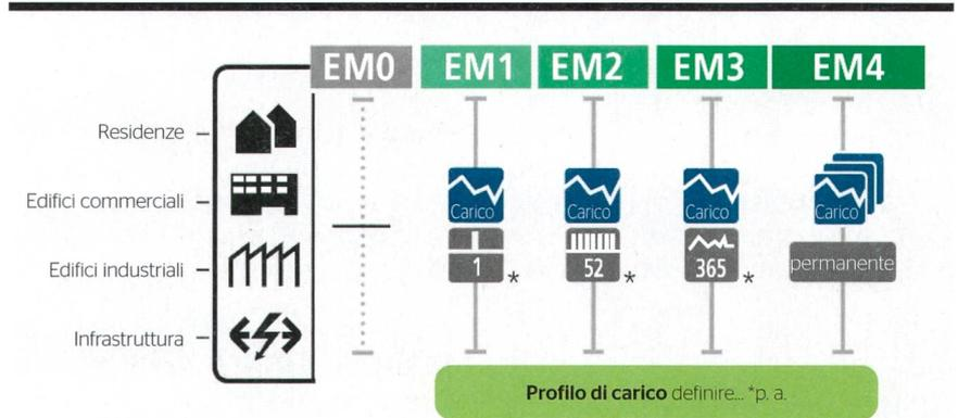
Figura 2 Esempio: Classe di efficienza energetica secondo il profilo di carico.
