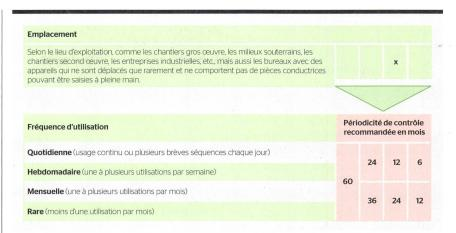
**Figure 1** Extrait du tableau A.1 Aide à la décision pour la détermination des intervalles de vérification.
