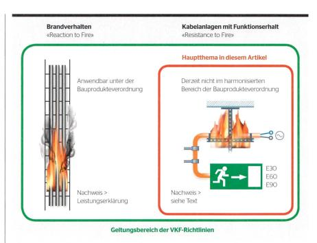
**Bild 1** Links die Brandeigenschaften «Reaction to fire», rechts der Funktionserhalt («Resistance to fire»), bei dem die Kabelanlage im Brandfall weiter funktionieren muss. Zusätzlich mit Geltungsbereich der VKF-Richtlinien.
