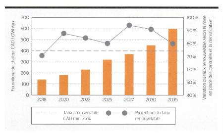
**Figure 2** Projection de la fourniture de chaleur via le réseau de chauffage à distance Fribourg à l'horizon 2035. Une croissance des raccordements de 20 à 30 GWh/an est envisageable.
