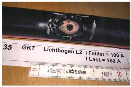
Bild 3 Fehlerstelle eines durch den Erdschluss beschädigten Versuchskabels.
