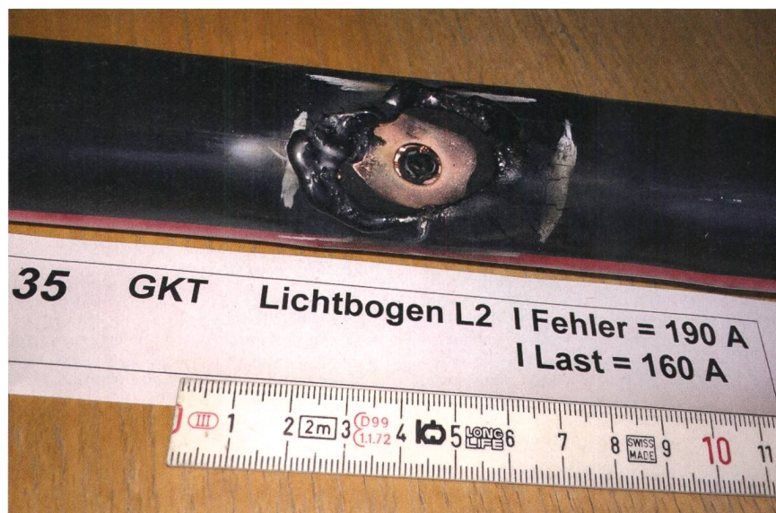
Bild 3 Fehlerstelle eines durch den Erdschluss beschädigten Versuchskabels.
