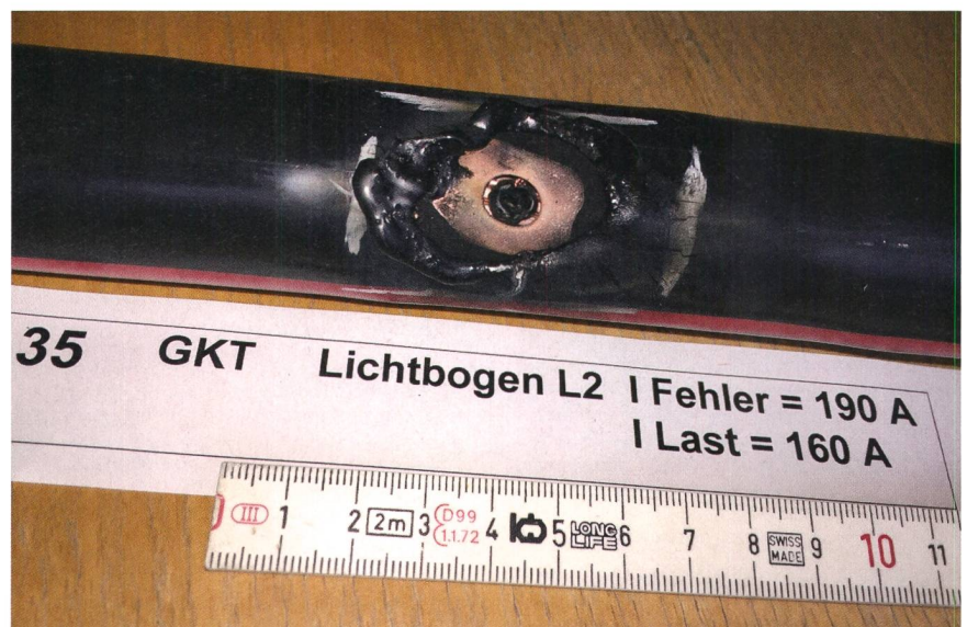
Bild 3 Fehlerstelle eines durch den Erdschluss beschädigten Versuchskabels.
