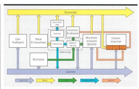
Die Power-to-Gas-Technologie platziert sich zwischen Strom- und Gasnetz und verbindet somit eine Reihe weiterer, bestehender Technologien in das Gesamtsystem ein.[1]
