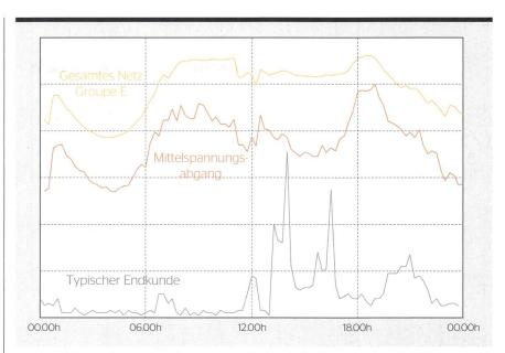
Bild 1 Typische Lastkurven im Netz von Groupe E.
