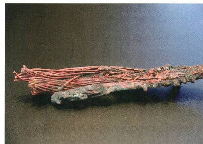
Um die Auswirkungen eines Kurzschlusses zu demonstrieren, brachte Werner Berchtold auch Schadensmuster wie dieses geschmolzene Kupferkabel mit.
