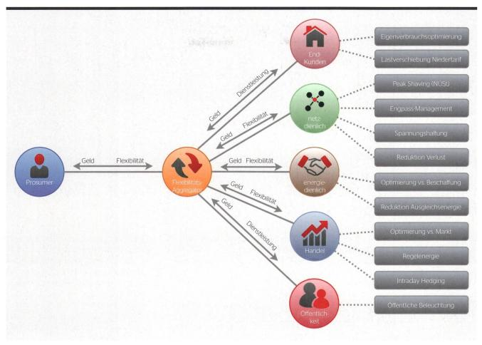
Bild 1 Anwendungsfälle Flexibilitätsmanagement und die Rolle des Flexibilitäts-Aggregators.
