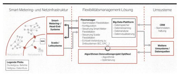
Bild 2 Vereinfachtes Prinzipschema der umgesetzten Lösung.
