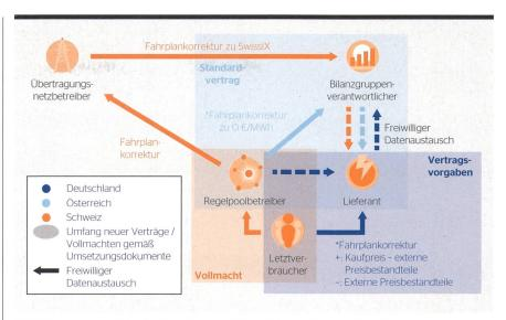
Bild 1 Prozess der Fahrplankorrektur bei bilanzübergreifendem Pooling.
