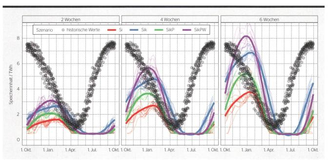
Bild 3 Historische und induzierte Mindestfüllstände für eine Selbstversorgungsfähigkeit von 2, 4 und 6 Wochen.
